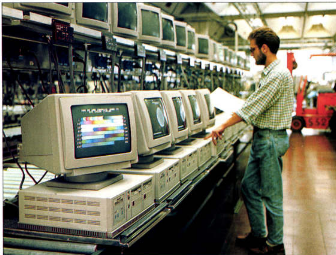
Les P500 et P800 sont fabriqués à l'usine de Scarmagno, près de Turin. Ils font appel à la technique du montage en surface des composants.
